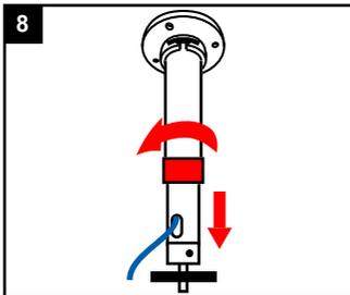
Lösen Sie die Verschraubung, ziehen Sie das Rohr in die gewünschte Länge und ziehen Sie die Verschraubung wieder an.
