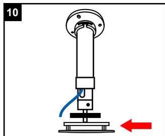
Schrauben Sie die Montageplatte an die untere Seite der Stange.
