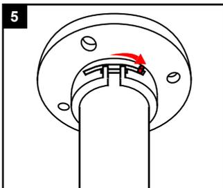
Drehen Sie die Stange, damit der Stift in der seitlichen Führung gehalten wird.
