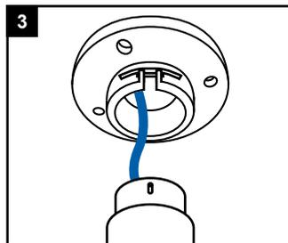
Ziehen Sie die Verkabelung durch die Teleskop-Stange hindurch.
