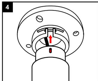
Schieben Sie die Stange in die Montageplatte, sodass der Stift in die Schiene geführt wird.
