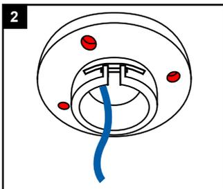
Befestigen Sie die Montageplatte an der Decke.
