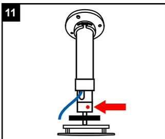
Richten Sie die Montageplatte in die gewünschte Position und ziehen Sie die Schraube fest.
